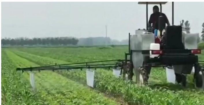
图 6 喷苗后除草剂用隔帘物理阻挡防漂移
